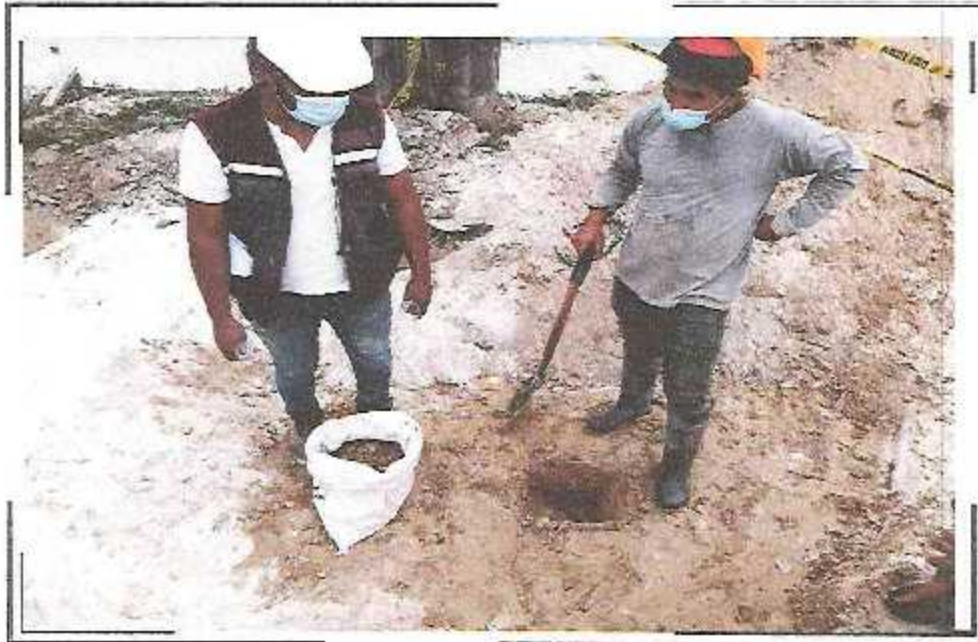
COLECCIÓN DE MATERIAL DE TERRENO NATURAL PSJ MIAMI TRAMO II (AV. JORGE CHAVEZ)
